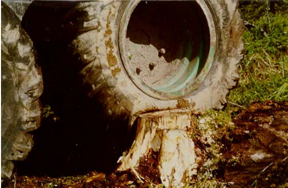
Kuva 4. Liian pieni paine, kannon päälle ajettaessa
