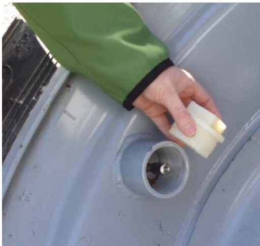
Kuva 2. Nokian led-painevahti venttiiliin kiinnitettynä
