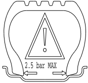
Kuva 6. Renkaan sivussa oleva merkintä maksimipaineesta rengasta vanteelle asennettaessa.
