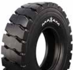
MS407 PORTXTRA IND-4 Teräsvyörengas teollisuuden ja satamien tarpeisiin Hyvä nostovakaus ja tasainen kosketuspinta • Stabiiloitu kulutuspinna • Hyvä lämmönkesto - edullinen tuntitulos • Vahva kylkirakenne
