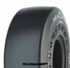
Maxam MS708 SM Umpikumirengas suunniteltu pistoherkille kuor- mausaluustoille
